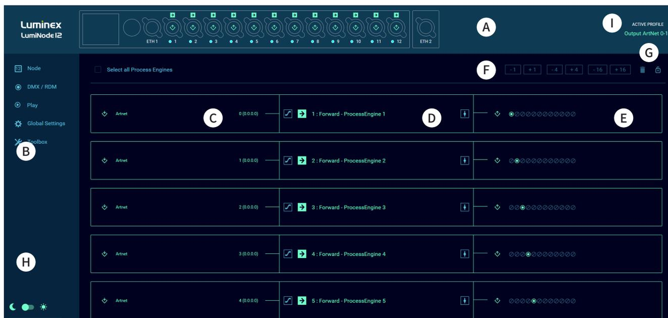
**(A) ルミノードの画像:** お使いのモデルによって画像が上記と異なる場合があります。この画像は各DMXポートの設定を表示しています。各DMXポート内の中心にあるアイコンは、そのポートが入力と出力のどちらなのかを表示しています。各ポートの上部には、そのポートにリンクしているプロセッシング エンジンのモードが表示されます。
